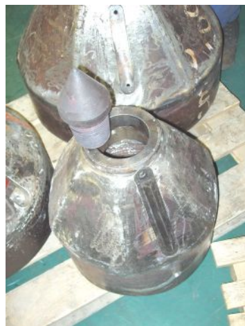
Инструмент для прокола грунта (наконечник конический) и расширителя
