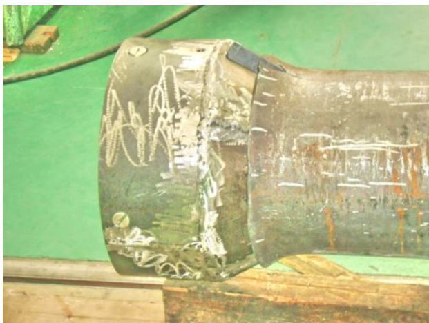
Инструмент для разрезания старой и протягивания новой трубы (расширитель с ножами)
