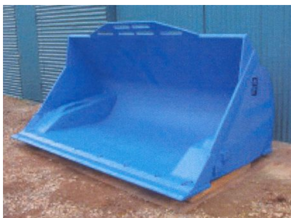
HL106-290-NNG-S208 Ковш фронтального погрузчика. Применяется для загрузки автомашин (контейнеров, бункеров) с высоким бортом (до 4 м.)
