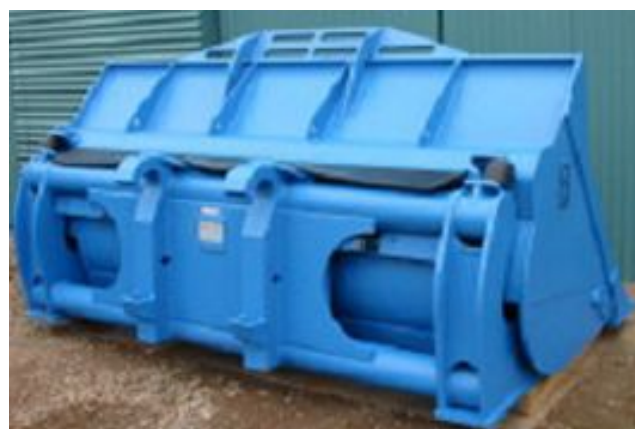
HL106-290-NNG-S208 Ковш фронтального погрузчика. Применяется для загрузки автомашин (контейнеров, бункеров) с высоким бортом (до 4 м.)
