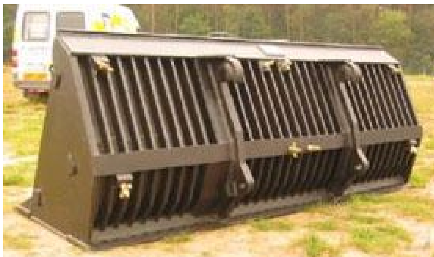
RS055-273-VOL Универсальный ковш с ребрами. Используется для строительства дорог, а также при работе в карьерах для сортировки пород
