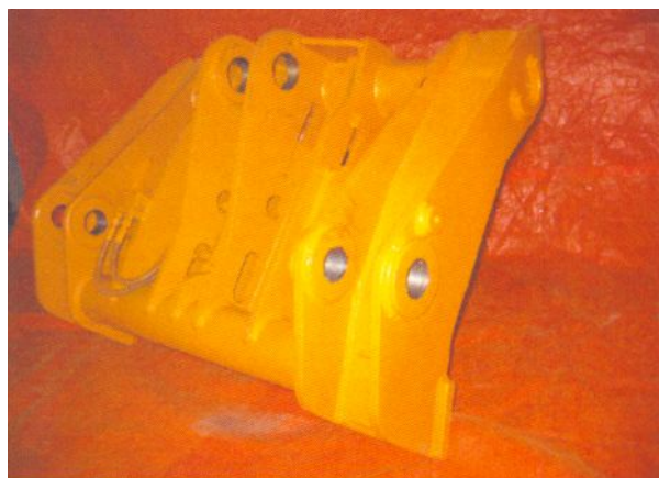
Quick-coupler: быстросъемный переходник, позволяющий быстро менять навесное оборудование на экскаваторах. Благодаря этой функции, одним экскаватором можно производить различные виды работ.
