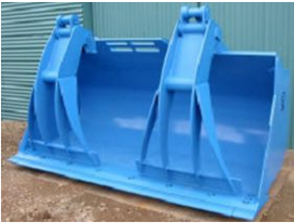
LCT097-290-NNG Ковш со специальными “лапами”. Используется для насыпного груза. “Лапы” предотвращают выпадение груза из ковшей в процессе транспортировки
