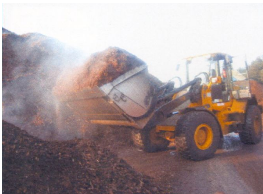
HL088-300-NNG-JCB436 Ковш фронтального погрузчика. Применяется для загрузки автомашин (контейнеров, бункеров) с высоким бортом (до 4 м.)
