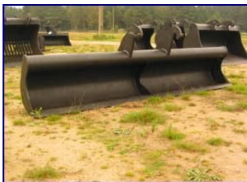
SL015-300-NNN Ковш для зачистки траншей, неглубоких кюветов и отделки наклонной части.
